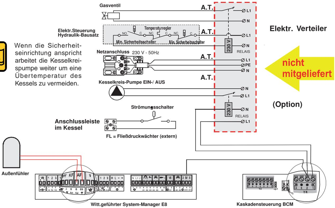
Hauptversorgung-, Gasventil-, Sicherheitseinrichtung-, drehzahlgeregelte Heizungspumpe, Außenfühler-, Strömungsschalter:
