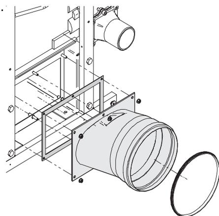
Schächte oder Schornsteine, die in eine Abgasleitung eingezogen werden, müssen der DIN V 18160 entsprechen. Bei der Aufstellung des Brennwertkessels im Dachgeschoß kann die Abgasleitung ohne Schacht direkt durch das Dach ins Freie geführt werden. Speziell dafür geeigneten Schacht eingezogen werden.
