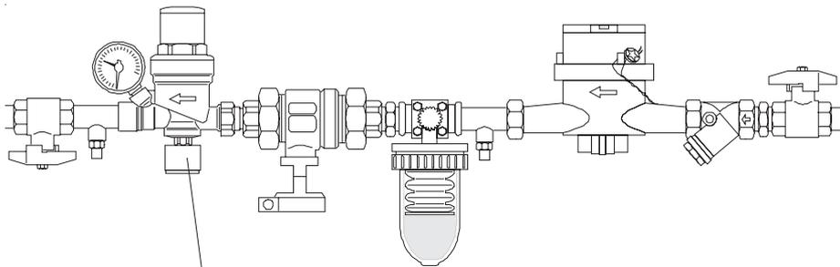
Fülleinrichtung mit Absperrventil
