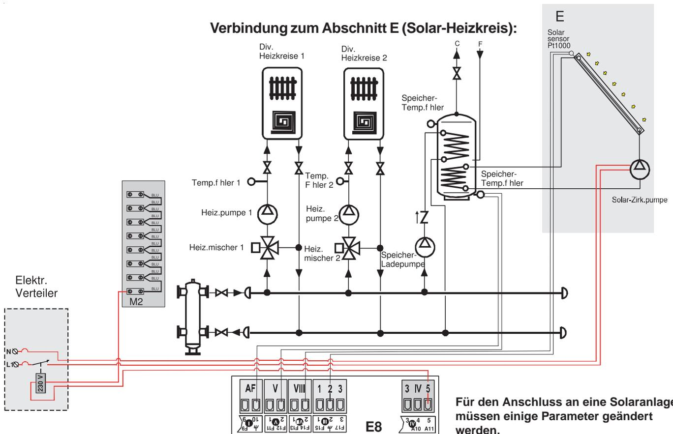
Für den Anschluss an eine Solaranlage müssen einige Parameter geändert werden,
