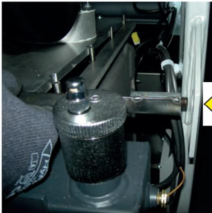
Die Schraube mit einem 4 mm Inbus-Schlüssel herausdrehen.
