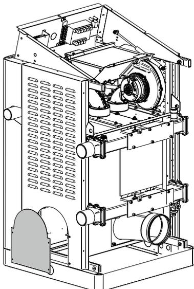
Um den Gasanschluss von rechts nach links umzusetzen, muss der Rohr-Flansch und die Blindplatte mit Dichtungen am Gasverteilerrohr gegeneinander ausgetauscht werden siehe Abbildung.
