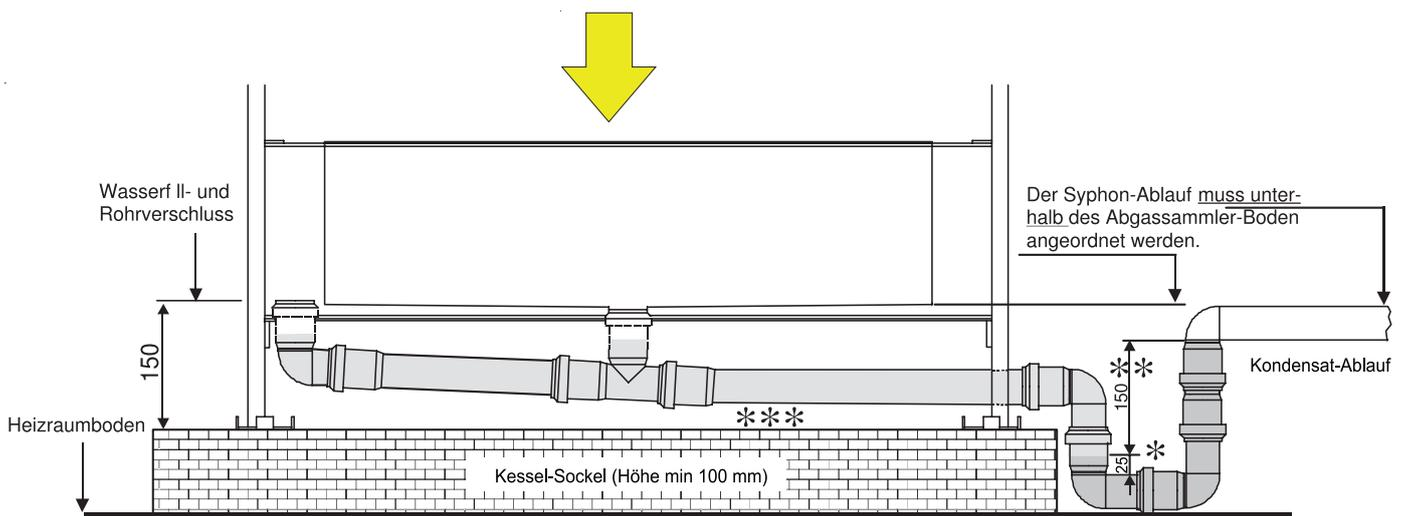
Der Auslauf der Kondensatabflussleitung erfolgt zur Anschlussseite des Abgassammlers. Dazu ist der vorgestanzte Teil an der Abdeckplatte zu entfernen.
