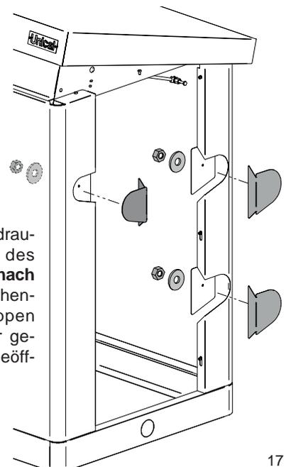
Nach einem Umbau der hydraulischen Anschlüsse und des Gasanschlusses von rechts nach links, muss die entsprechende Öffnung mit PVC-Kappen verschlossen und auf der gegenüber liegenden Seite geöffnet werden.
