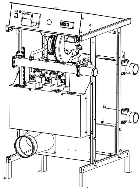
1. Zunächst wird die Kessel-Verkleidung entfernt.
