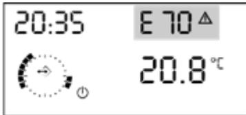
Bei Auftreten eines Fehlers in der Heizungsanlage, erscheint ein blinkendes Warndreieck und die zugehörige Fehlernummer im Display des Reglers. Die Bedeutung des angezeigten Fehlercodes kann der folgenden Tabelle entnommen werden. Nach Behebung eines Fehlers sollte die Anlage neu gestartet werden => **RESET**
