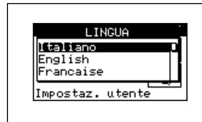
Wird eine Sprache falsch ausgewählt, 30 Minuten warten, so dass sich die CCI automatisch auf die Haupt-Bildschirmseite zurückstellt, anschließend wie folgt vorgehen:
