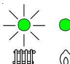
Wird die Taste mindestens 3 Sekunden lang gedrückt, geht der Brenner auf maximale Leistung (Anzeige **D** blinkt, Anzeige **E** leuchtet stetig).
