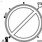
Mit diesem Drehschalter kann der Boiler eingeschaltet und die Temperatur des Brauchwassers geregelt werden:
