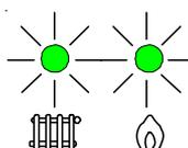
Wird die Taste noch einmal kurz (< 3 Sek.) gedrückt, geht der Brenner auf Minimalleistung (beide Anzeigen **D** und **E** blinken).
