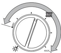
Steht der Bezugspunkt des Drehschalters auf dem nebenstehend dargestellten Feld, befindet sich der Kessel im "Winter"-Modus, und regelt die Temperatur des Wassers des Heizkreislaufs. Die Regulierung kann im Bereich von mind. 30°C bis höchstens 80°C ausgeführt werden.
