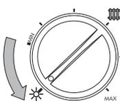
Steht der Drehschalter auf ☁ (Sommer) bedeutet dies, dass der Heizbetrieb ausgeschaltet ist, die Frostschutzfunktion aber weiterhin funktioniert.
