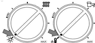
Der Kessel verfügt über ein Frostschutzsystem, das in Funktion tritt, wenn die Temperatur des Systemwassers unter 6°C absinkt: Brenner und Pumpe gehen in Betrieb bis die Temperatur in der Anlage 16°C erreicht hat.
