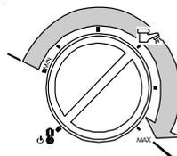
Steht der Drehschalter wie hier seitlich abgebildet, kann die Brauchwassertemperatur eingestellt werden. Die Regelung ist zwischen 25°C und 60°C möglich.
